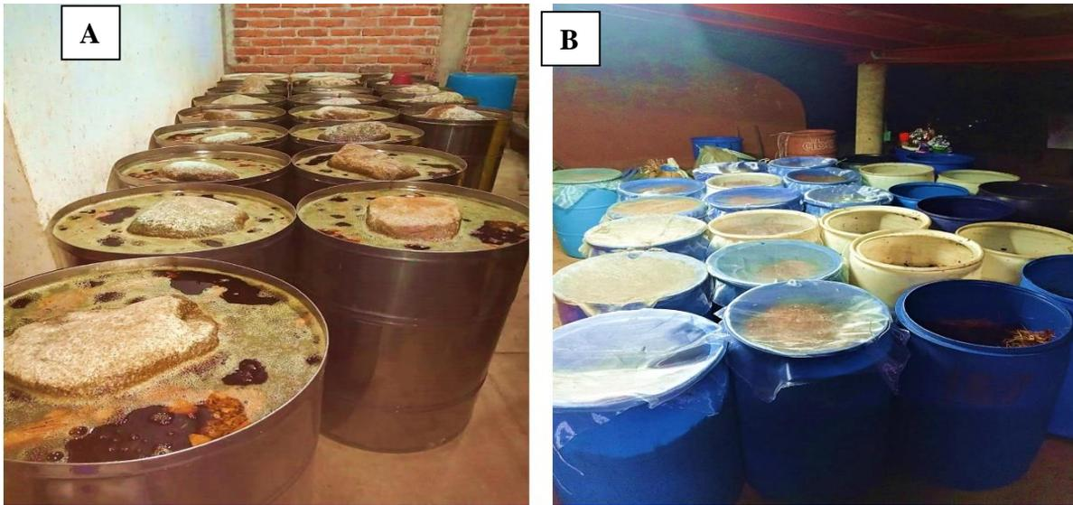
**Figura 9.** Etapa de fermentación de mostos de agave A) Tambos de acero inoxidable en fermentación de la costa B) Tambos de plástico en fermentación de la sierra
