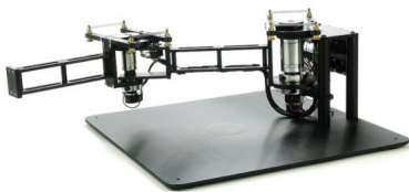
Figura 2.2: Un ejemplo de sistema Clase II es un robot de 2 GDL con una articulación flexible.
