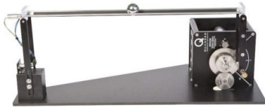
Figura 2.1: Un ejemplo de sistema Clase I es el sistema bola-barra.
