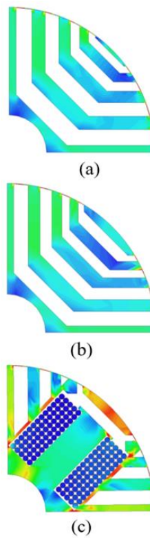
Figura 5.22. Densidad de flujo magnético de las tres estructuras del rotor: (a) estructura inicial, (b) estructura optimizada, (c) estructura con bobinas de excitación externas [78].
