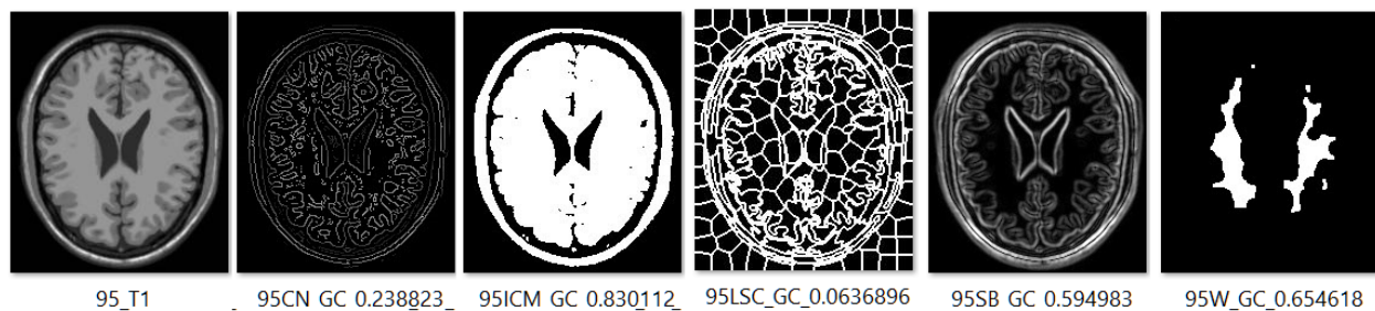
Figura 5.34. Ejemplos de segmentación. Métrica aplicada: Contraste del Nivel de Gris (GC)
