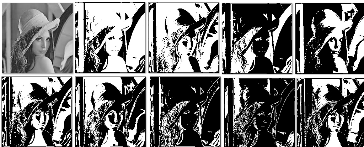
Figura 4.4. Segmentación experimental con ICM. Imagen JPG de Lena en escala de grises (225x225 píxeles)
