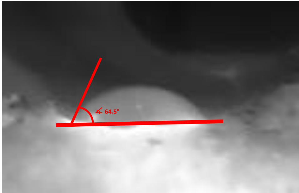
Figura 4. 16 Ángulo de contacto del acrílico y agua
