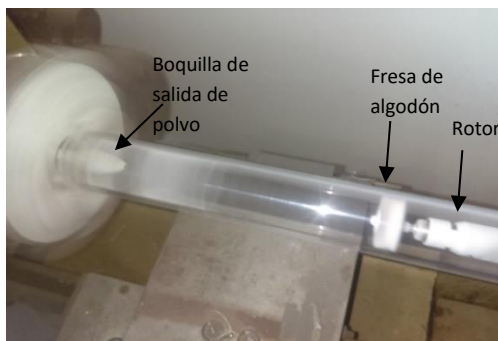
Figura 3. 18 Adaptación de equipo para proceso de triboadhesión en tuberías de acrílico
