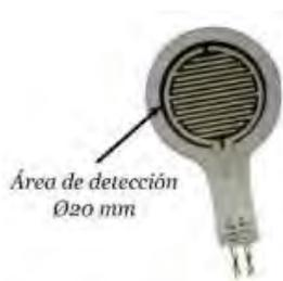
Figura A - 2. Sensor de fuerza resistivo IMS-C20B.
