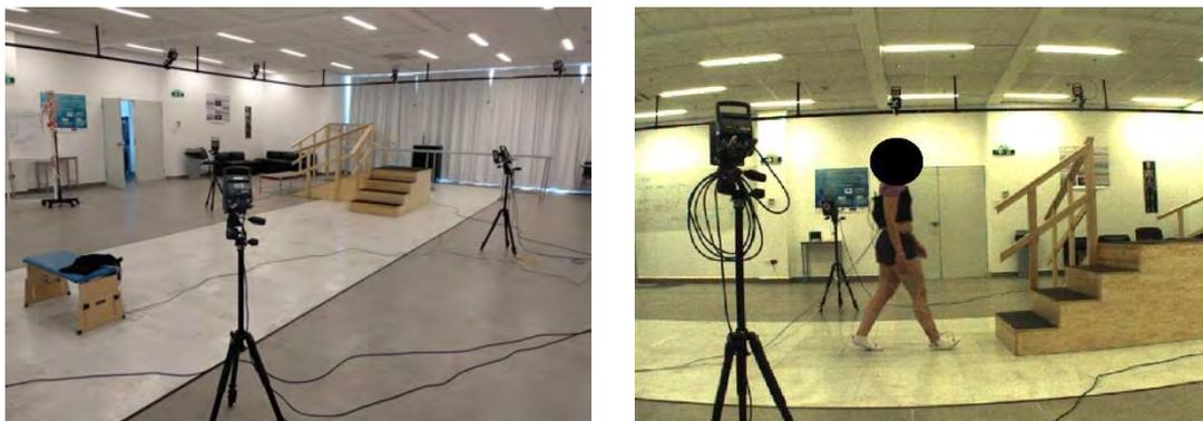
Figura 3.6. Pruebas de laboratorio para el análisis de marcha. Izquierda: el espacio calibrado para las pruebas se definió para el registro de un mínimo de tres ciclos de marcha a nivel completos previo al ascenso de cuatro escalones. Derecha: participante instrumentada en la realización de una prueba para la adquisición de señales.
