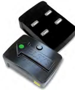
Figura A - 3. Sensor *Trigno* de DELSYS utilizado para el registro de señales mioeléctricas de superficie.
