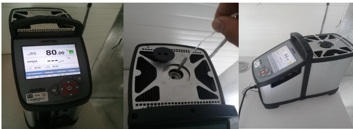
759 Figura 3.1 Calibración de RTD en pozo seco JOFRA.
