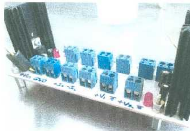
Figura 3.43 Fabricación de la tarjeta de acondicionamiento de señales.
