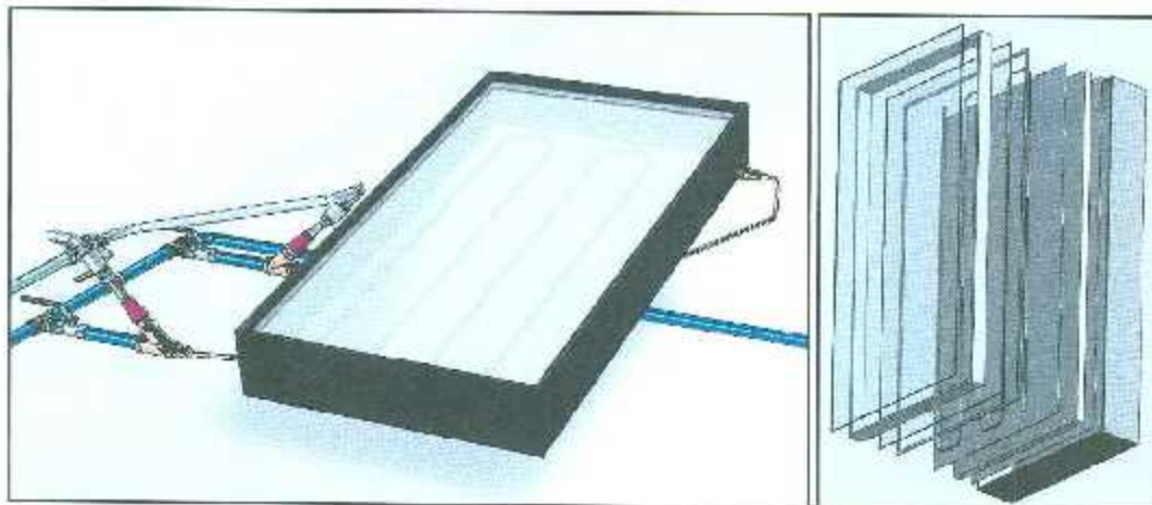
Figura 3.7. Diseño en SolidWorks del colector solar plano utilizado para el precalentamiento de agua de alimentación.
