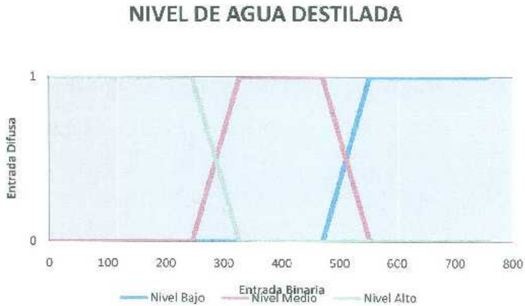
Figura 3.54. Gráfica de la función de pertenencia de la variable nivel de agua destilada en tanque diario.
