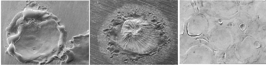
Figura 2.14 Cráteres formados por el metal fundido [6].
