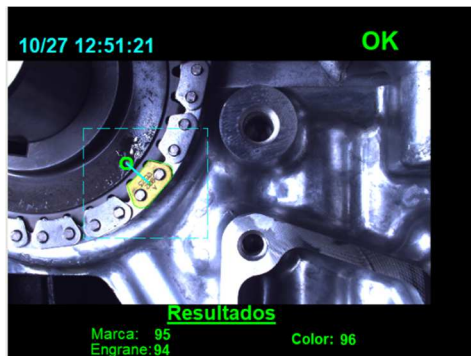
Figura 5.11 Absorbe defecto con exceso de grasa.
