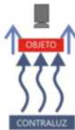
Figura 1.5 Método de iluminación Darklight (DCM Sistemas, 2020).
