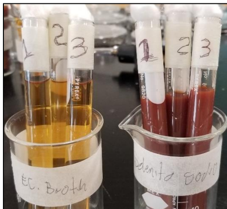
Ilustración 20 Figura 6.6.2 Caldos EC-Broth y Selenito de sodio inoculados con muestras de agua residual.
