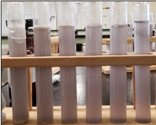
Figura 6.4.10 Muestra fuente de contaminación con tintes de industria textil.
