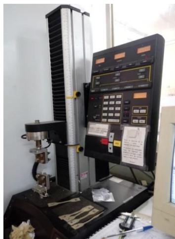
**Figura 3.** Prueba de tensión en texturómetro Instron modelo 4442 de acuerdo con la norma ASTM D-638
