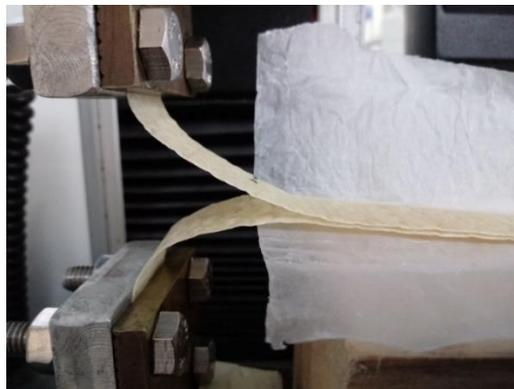
**Figura 4.** Prueba de adhesividad en texturómetro Instron modelo 4442 de acuerdo con la norma ASTM D-3330
