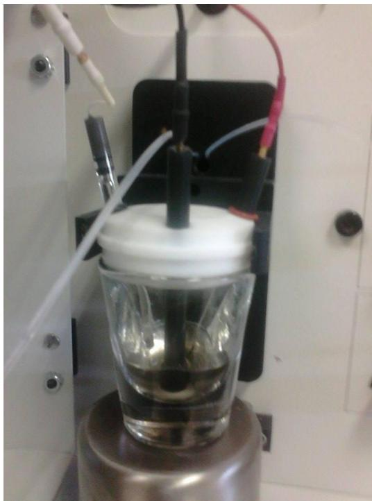
Figura 2.4. Celda electroquímica.
