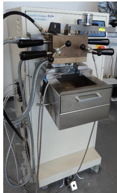
Figura 2.4 Cámara de mezclado empleada en la preparación del compuesto.
