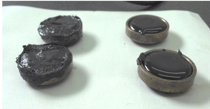
Figura 3.10 Muestras de las regiones superior e inferior del tubo de la prueba de separación de fases de la mezcla 600.
