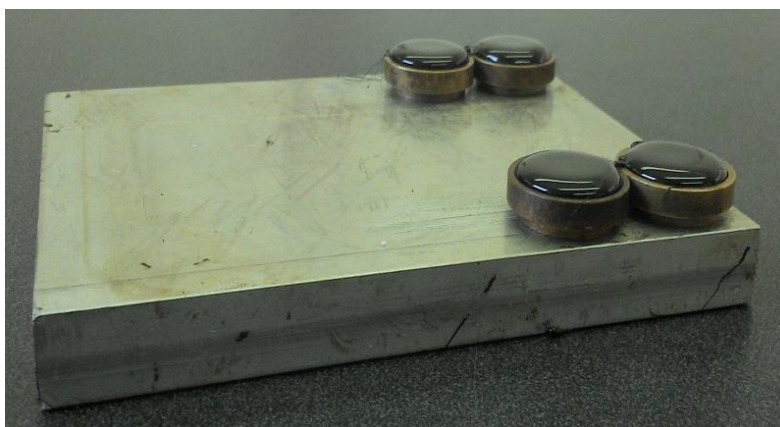
Figura 3.11 Muestras tomadas de las regiones superior e inferior del tubo de la prueba de separación de fases de la mezcla 310-n.
