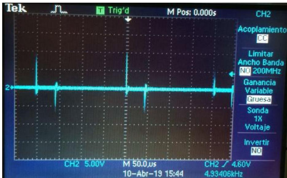
**Figura 5.22:** Señal recolectada de la línea en el receptor posterior a la etapa de amplificación, la señal es  $V_{ok}$  correspondiente a la salida del amplificador mostrado en la Figura 4.10.
