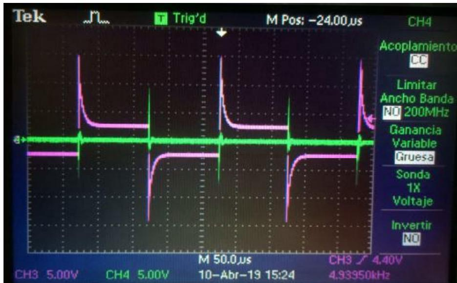
Figura 5.14: Señal en la entrada inversora  $V_{ok}$  (verde) y señal en la entrada no inversora  $V_{ref1}$  (rosa) del circuito reconstructor de señal mostrado en la Figura 4.11.
