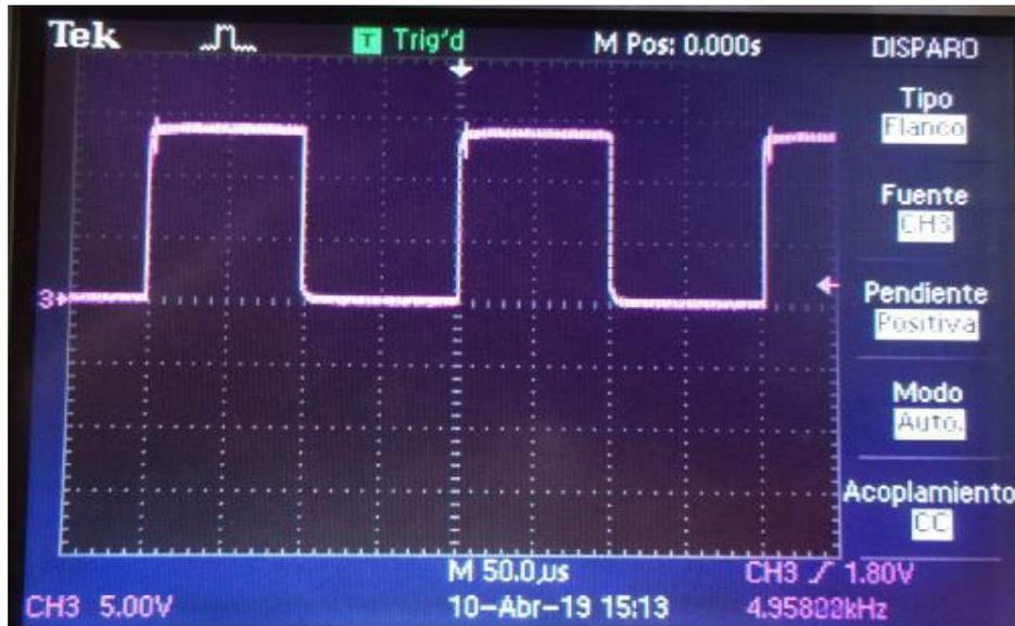
Figura 5.9: Señal  $PWM_1$  a la salida del generador de señal en transmisor mostrado a la Figura 4.2.
