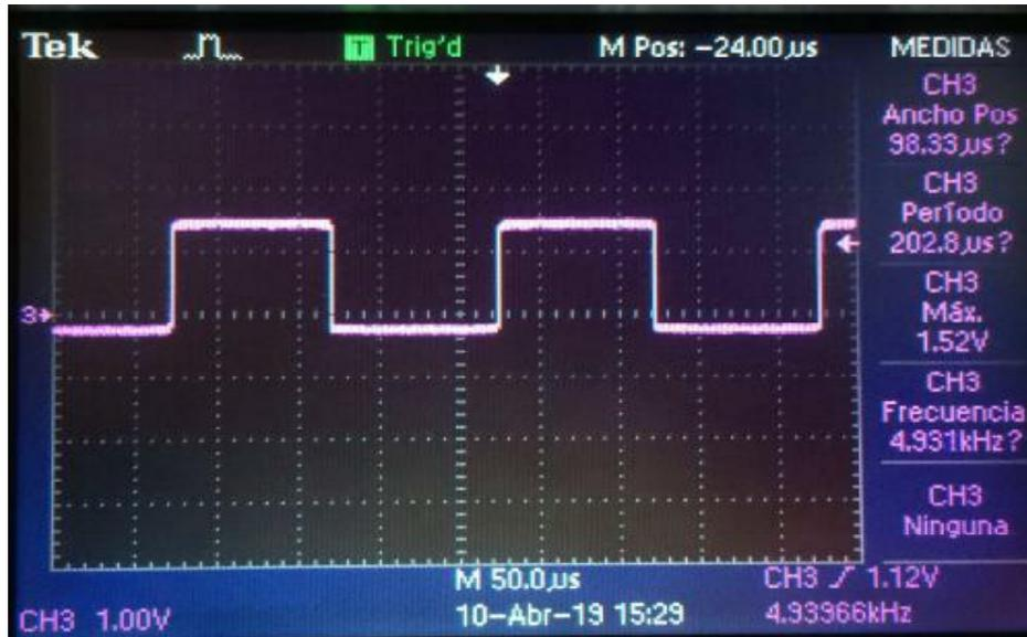
**Figura 5.16:** Señal  $PWM_{ctrl}$  correspondiente a la salida de la Figura 4.13. Esta señal es salida del receptor que es enviada a la etapa de potencia y es la reconstrucción de la señal PWM originalmente generada en el transmisor.
