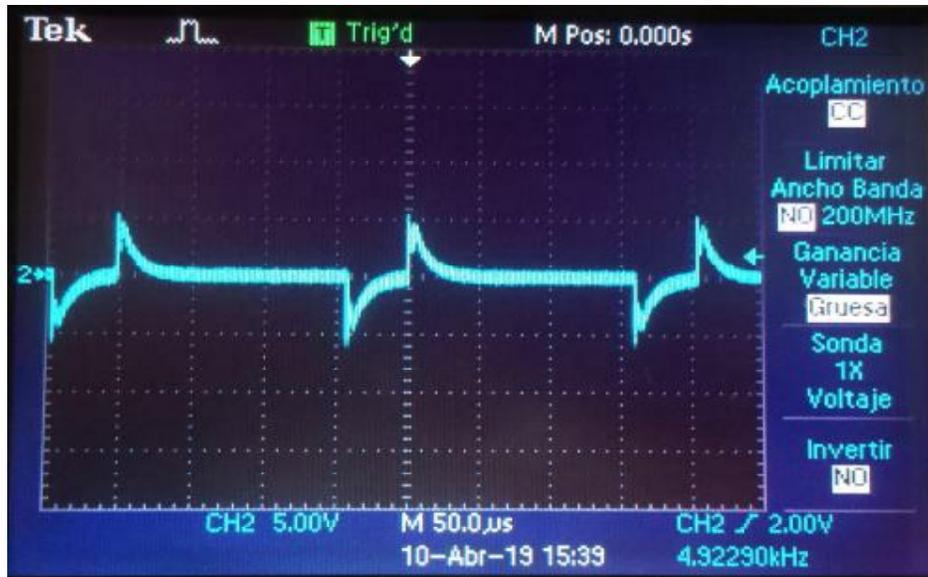
Figura 5.19: Señal  $S_{ft}$  a la salida del filtro del transmisor mostrado en la Figura 4.4.
