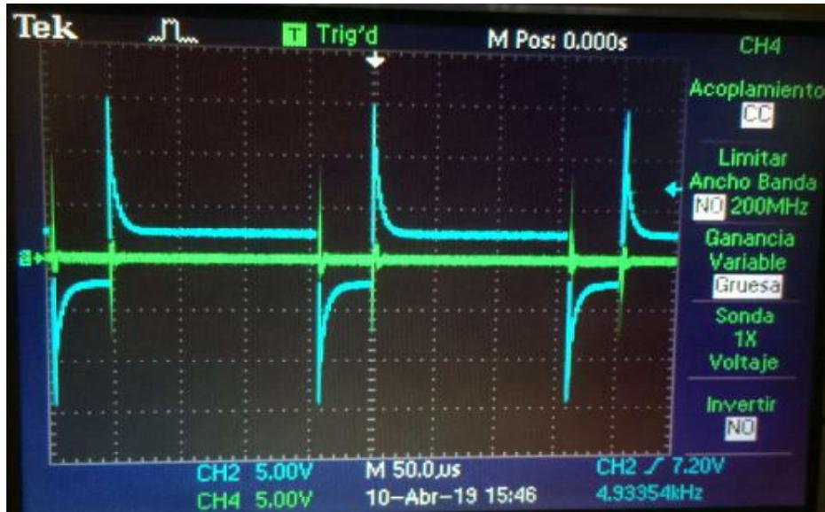
Figura 5.23: Señal en la entrada inversora  $V_{ok}$  (verde) y señal en la entrada no inversora  $V_{re_{f1}}$  (cian) del circuito reconstructor de señal mostrado en la Figura 4.11.
