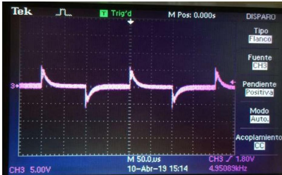
Figura 5.10: Señal  $S_{ft}$  a la salida del filtro del transmisor mostrado en la Figura 4.4.
