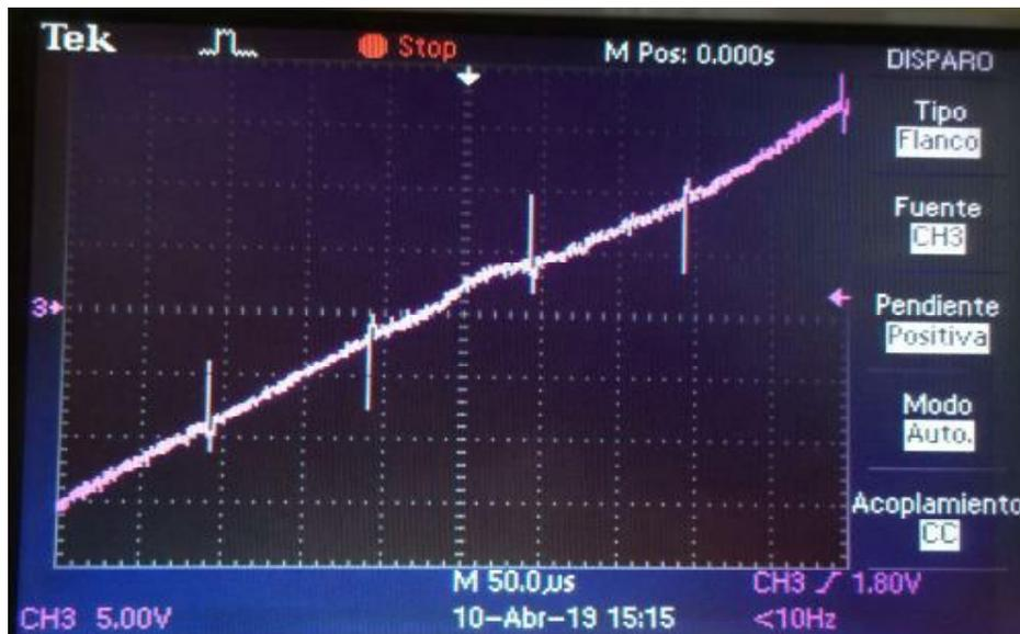
Figura 5.11: Señal presente en la conexión entre la línea y la salida del transmisor. Espigas de voltaje son observadas sobre la señal de C.A.
