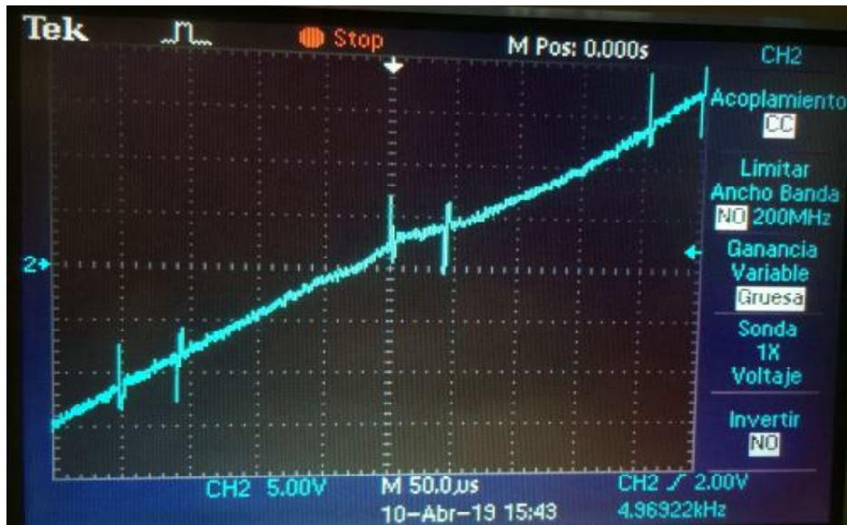
**Figura 5.21:** Señal presente en la conexión entre la línea y la entrada del receptor. Espigas de voltaje son observadas sobre la señal de C.A.
