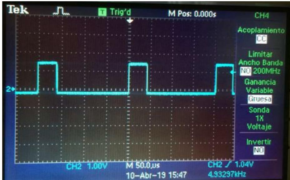
**Figura 5.25:** Señal  $PWM_{ctrl}$  correspondiente a la salida de la Figura 4.13. Esta señal es la señal de salida del receptor que es enviada a la etapa de potencia y es la reconstrucción de la señal PWM originalmente generada en el transmisor.
