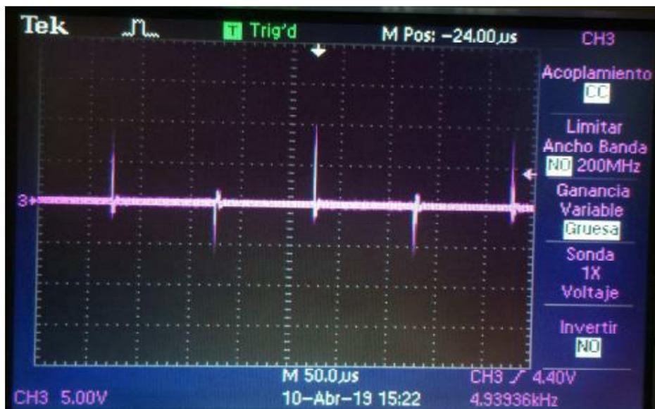
**Figura 5.13:** Señal recolectada de la línea en el receptor posterior a la etapa de amplificación, la señal es  $V_{ok}$  correspondiente a la salida del amplificador mostrado en la Figura 4.10.
