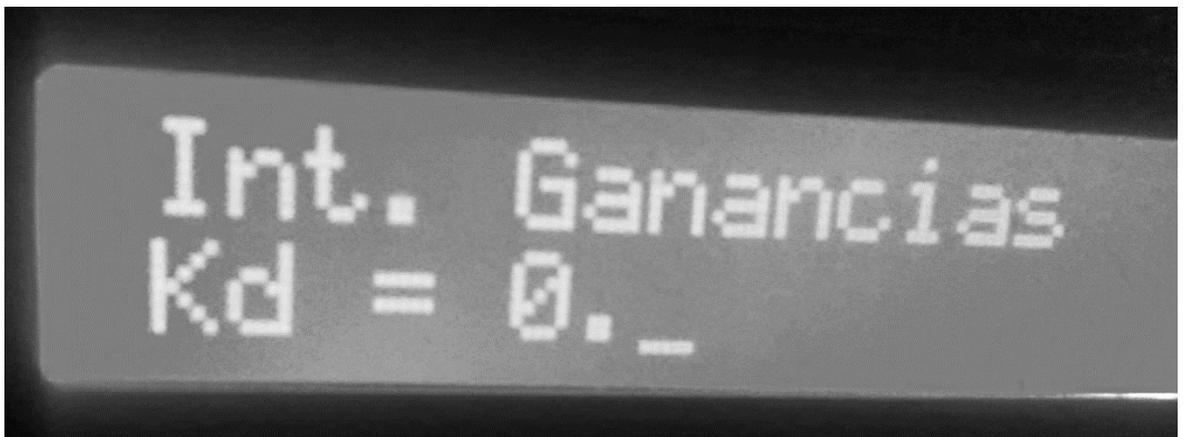
**Figura 5.17.** *Introducción de la ganancia  $K_d$  al sistema.*
