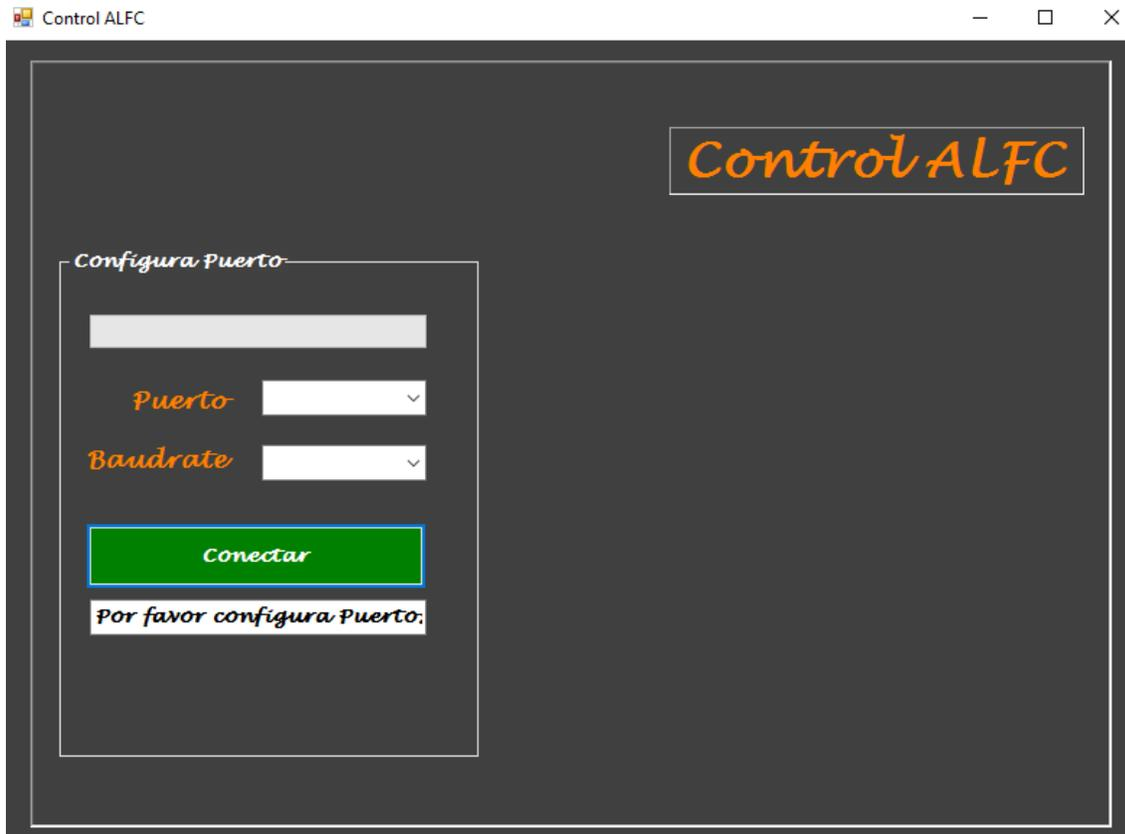
**Figura 5.23.** Mensaje de error si se pulsa el botón “Conectar” antes de elegir la configuración del puerto COM.
