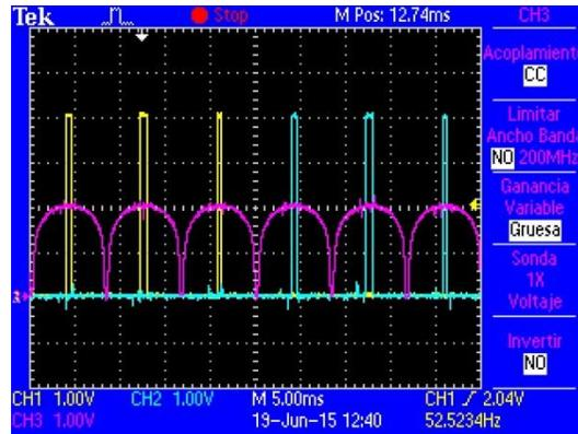
**Figura 5.8** Señal de control para generar una onda de CA de 20Hz en la salida del convertidor.
