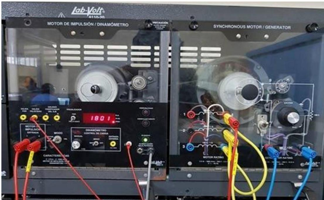
**Figura 2.11** Sistema de generación implementado.
