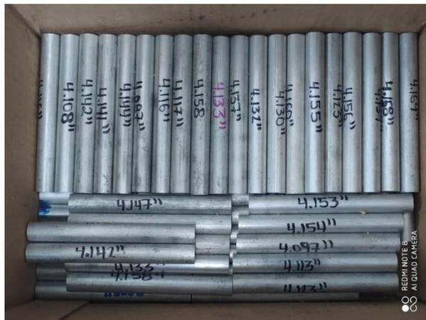
**Figura 4.8** Barras de aluminio 6061-T6 cortadas en tramos.
