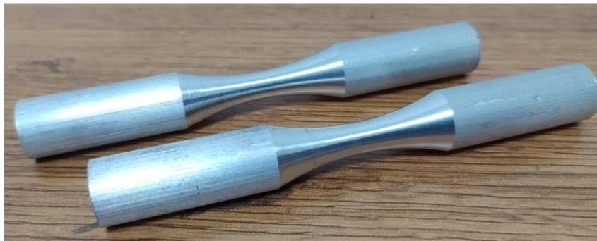
**Figura 4.10** Probetas de aluminio 6061-T6.
