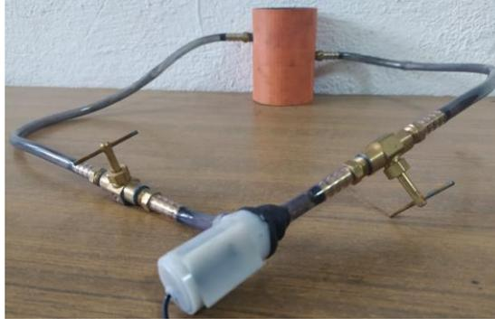
**Figura 4.21** Sistema hidráulico para el control de temperatura en el proceso de electrodeposición.
