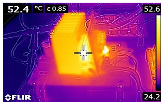
Figura C-5. h) Formas de onda de las salidas del inversor libre de falla (voltaje y corriente), lectura del sensor de temperatura (L. morada) y Señal de falla (L. azul), i) Desactivación de todas las salidas del inversor bajo los efectos de falla y j) Foto térmica de la lectura de la cámara en el momento de ocurrir la falla.
