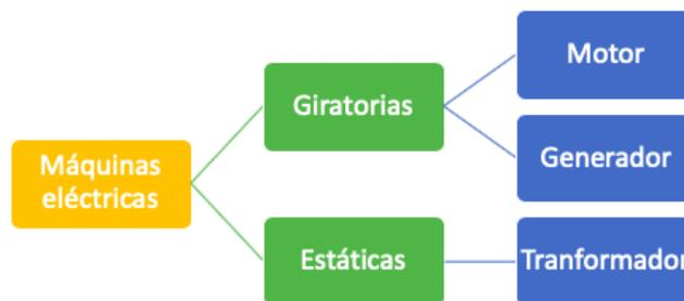
Figura 2.1: Clasificación de máquinas eléctricas.
