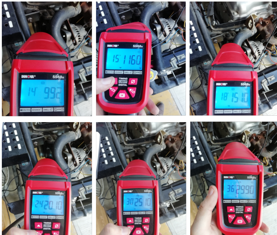
Figura 4.16: Ángulos de encendido a diferentes velocidades.
