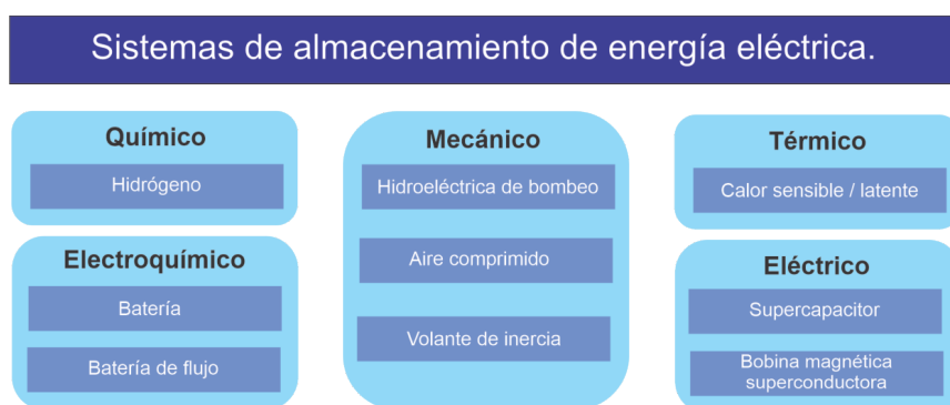
Figura 1.1: Clasificación de los sistemas de almacenamiento de energía.
