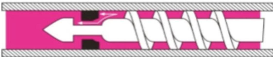
**Figura 7** A) Válvula cerrada B) Válvula Abierta
