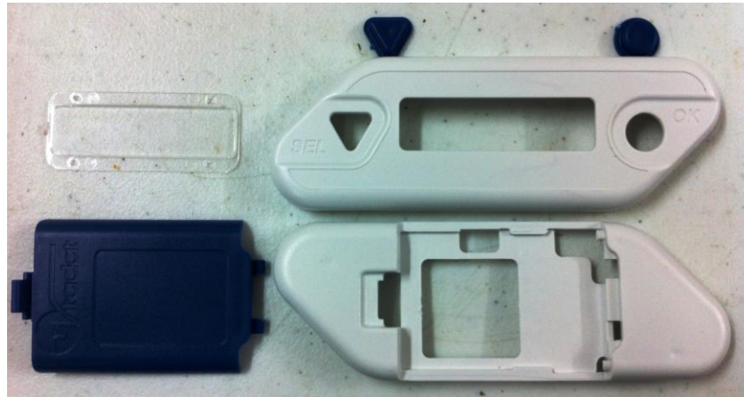
Figura 4-6.- Plásticos inyectados del molde final
