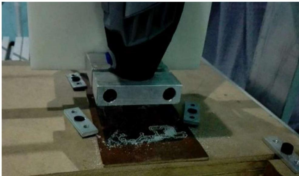
**Figura 4.13.** Fresado del PCB de prueba. Fuente: Elaboración propia.
