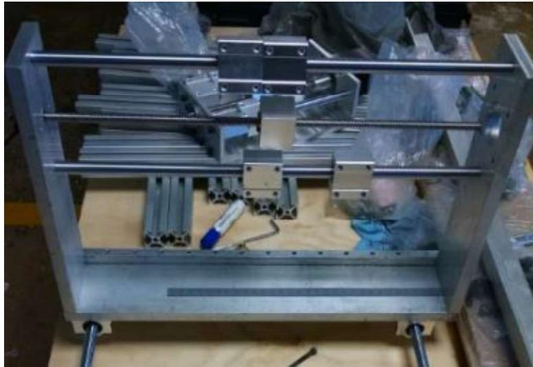
Figura 4.1. Montaje del eje X. Fuente: Elaboración propia.
