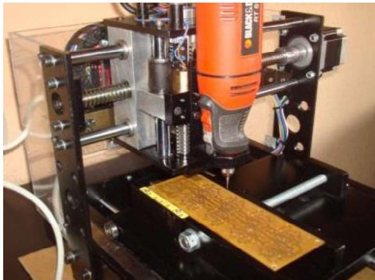
**Figura 1.5.** *Fabricación de circuitos impresos por CNC.*
