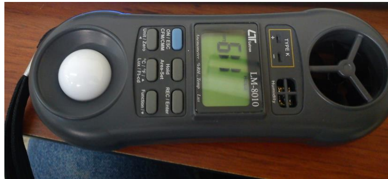
Figura 3.2: Fotómetro Lutron LM-8010.
