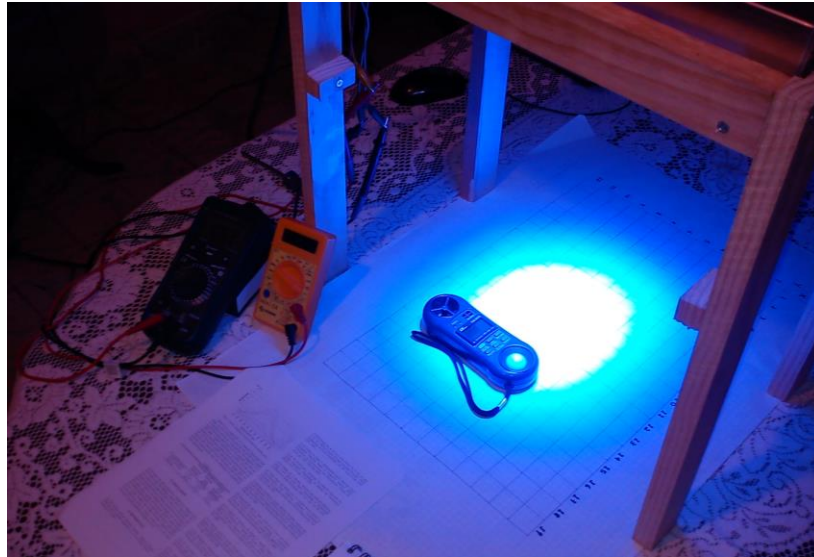
Figura 3.8: Medición de Iluminancia hacia los extremos del área iluminada.
