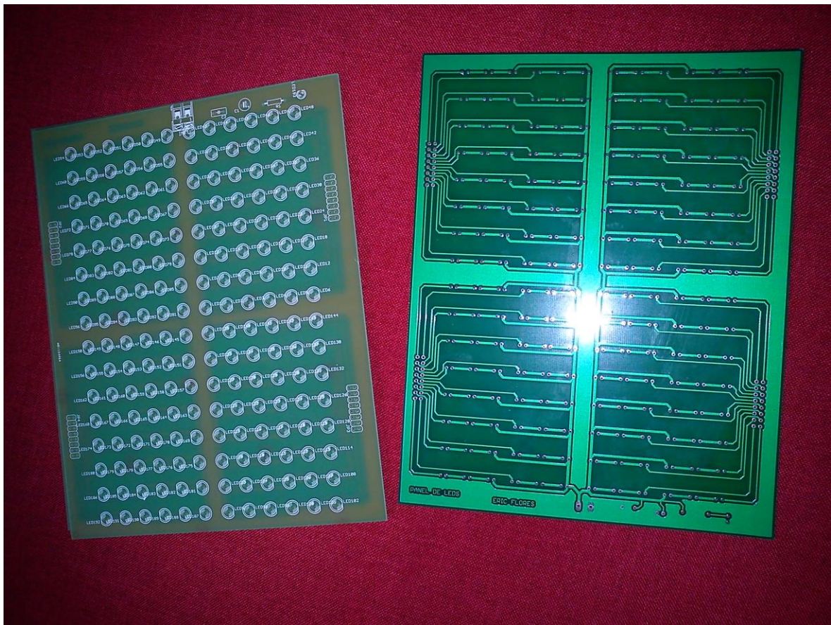
Figura 2.7: Fabricación del PCB del circuito panel de leds.
