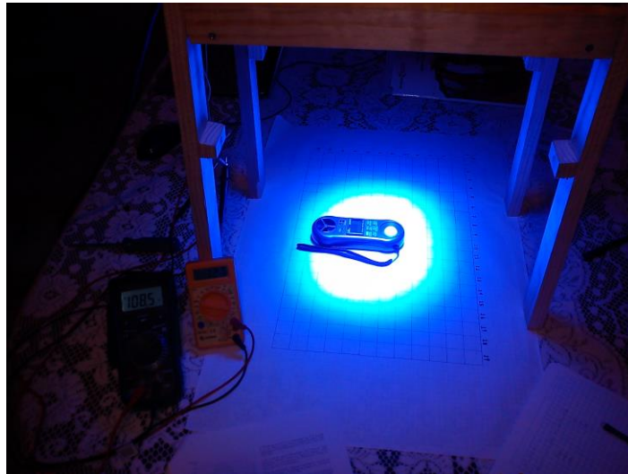
Figura 3.5: Medición de Iluminancia.
