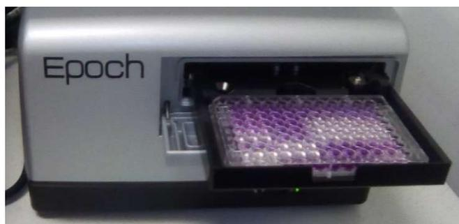
**FIGURA 5.5. Lectura de Charola de 96 pozos con MTT en espectrofotómetro Epoch.**
