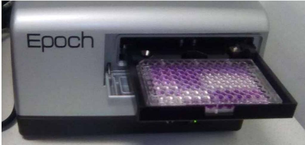
**FIGURA A4. Lectura de Charola de 96 pozos con MTT en espectrofotómetro Epoch.**
