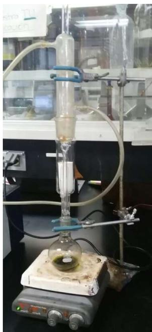
**FIGURA 5.4. Equipo de extracción Soxhlet**
