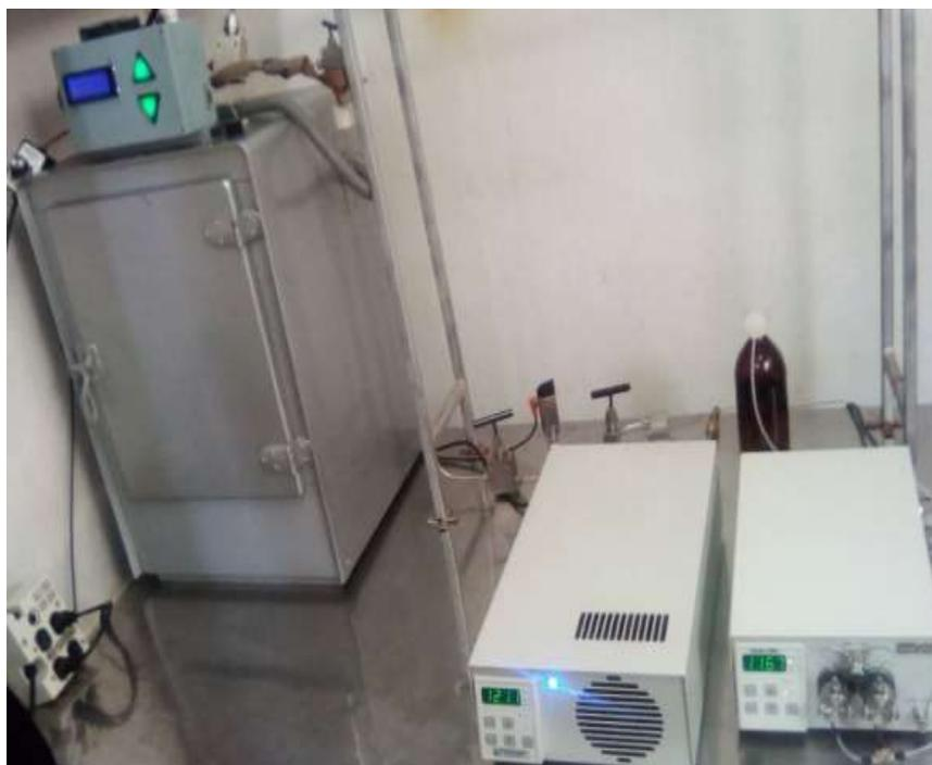
**FIGURA 5.3. Extractor de fluidos supercríticos.**
