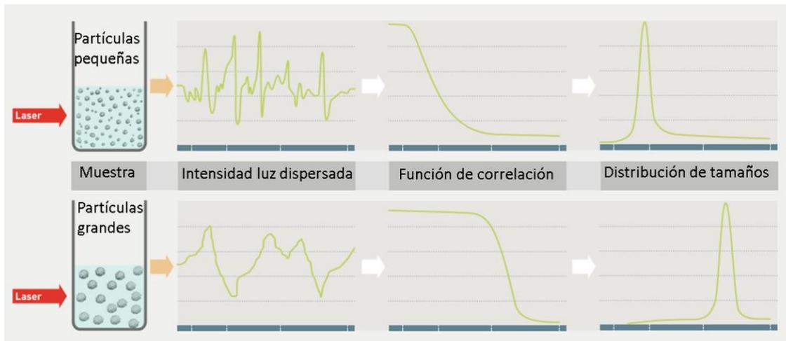
**FIGURA 18. Esquema funcionamiento de la técnica DLS en el equipo ZetaSizer Nano ZS90.** (Malvern Inc. 2013).
