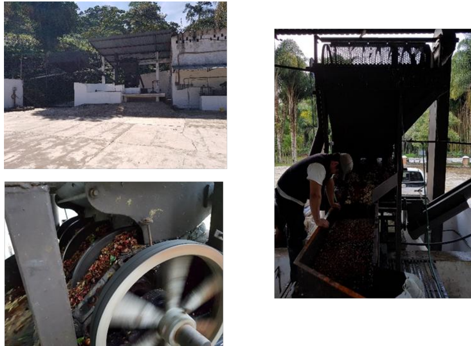
FIGURA 6.3. Despulpado de la cereza de café.
