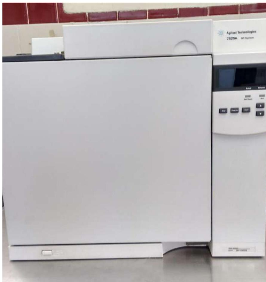
FIGURA 65. Cromatógrafo de gases 7820A (G4350A)
