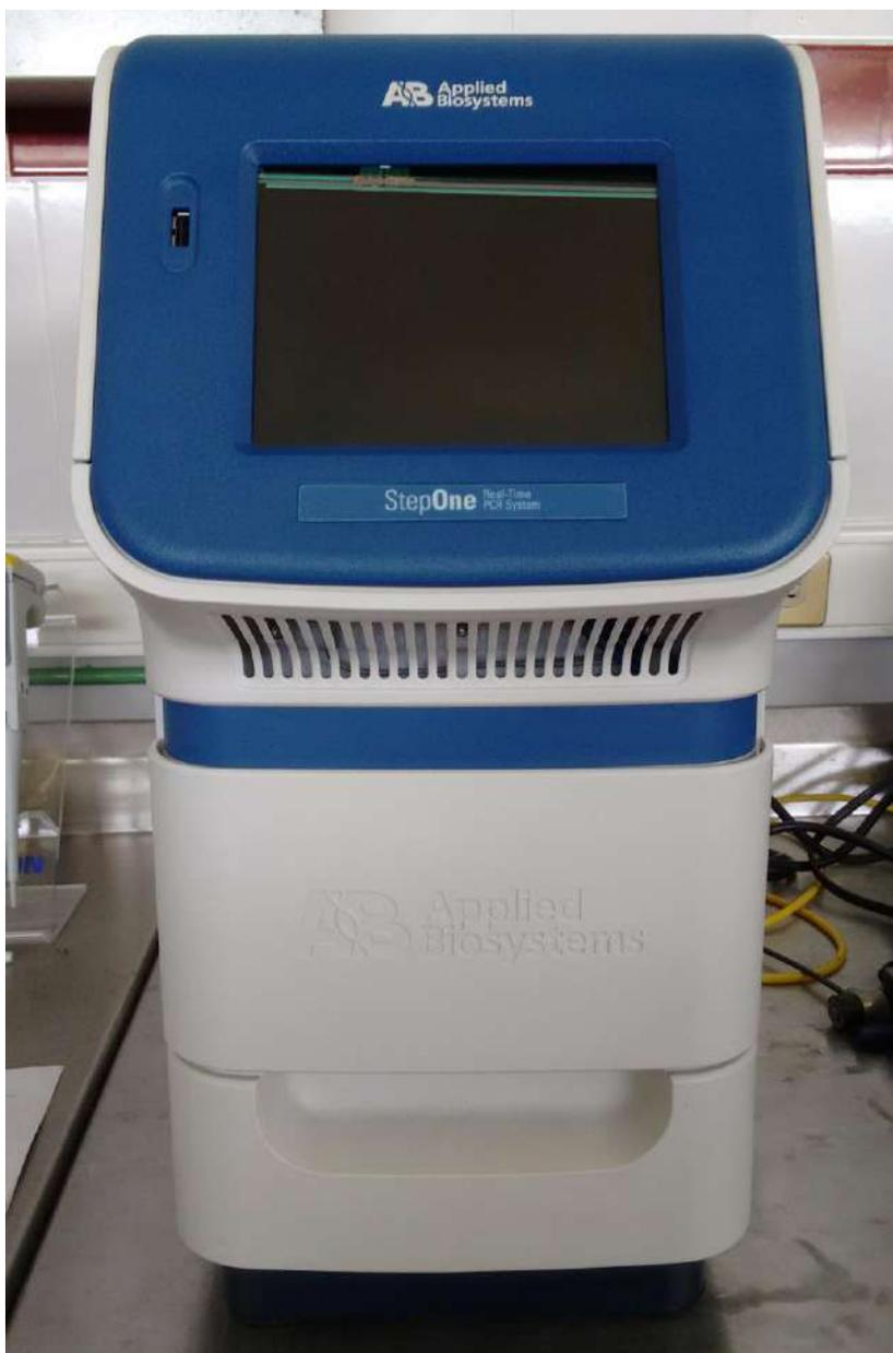
FIGURA 64. Equipo Step One de Applied biosystems
