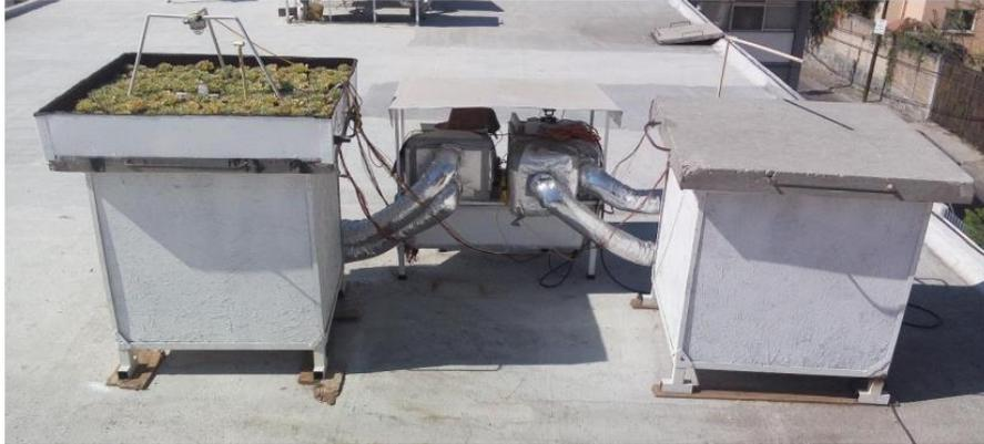
Figura 4.2 Módulos de prueba con techo verde y techo tradicional.
