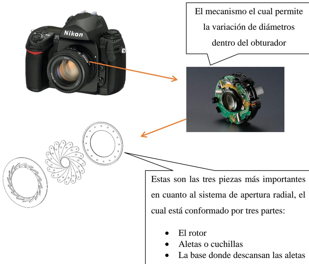
Figura 41. Visualización de los componentes principales en el mecanismo de apertura radial dentro de un obturador de cámara fotográfica (Fuente: Nikon (2020)).
