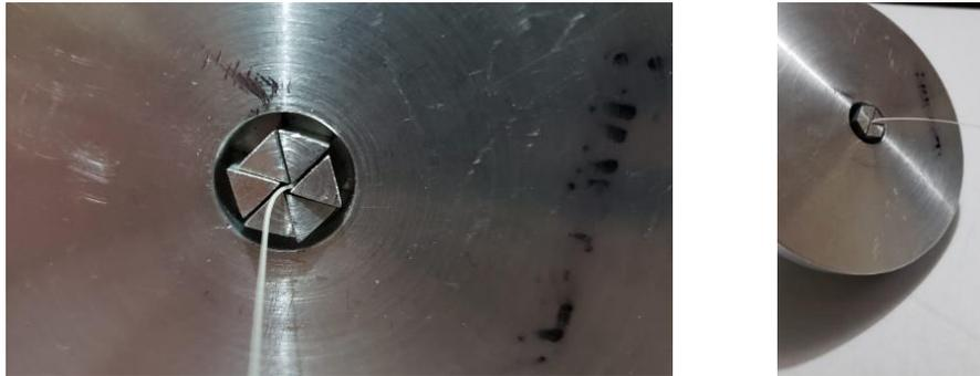
Figura 122. Diámetro de extrusión del filamento dado por el mecanismo de diámetro variable.
