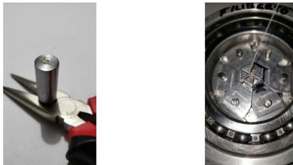
Figura 121. Visualización del mecanismo por desbordamiento de filamento en el plato base.
