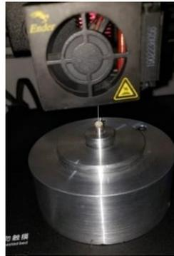
Figura 118. Retiro del mecanismo de diámetro variable del *hotend* de la impresora 3D.
