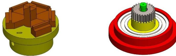
Figura 91. Presentación del ensamblaje entre el rotor y las cuchillas, así como la colocación del engranaje de 25 dientes con sus respectivos tornillos prisioneros.
