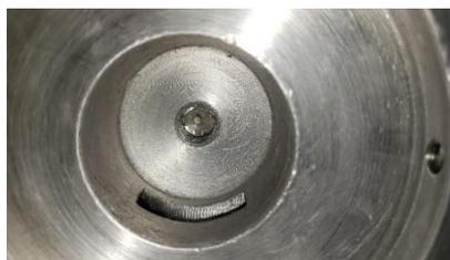
Figura 119. Visualización de errores en el mecanismo por desbordamiento de filamento en la tapa.
