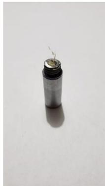
Figura 120. Visualización de errores en el mecanismo por desbordamiento de filamento en el tubo guía.
