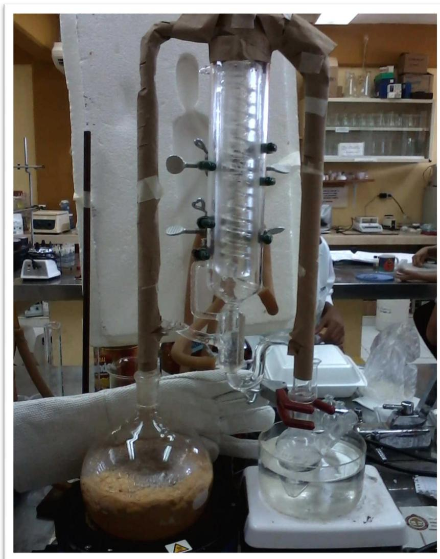
**Figura 10.** Equipo utilizado para la extracción de la fracción volátil de la pulpa de ciruela *Chi abal*, *Ek abal* y *Campech abal* por el método Likens y Nickerson.
