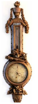
Figura 2.2 Barómetro. Mide la presión atmosférica, es decir, la que ejerce el aire sobre la Tierra. Fue inventado por Evangelista Torricelli en el siglo XVII
