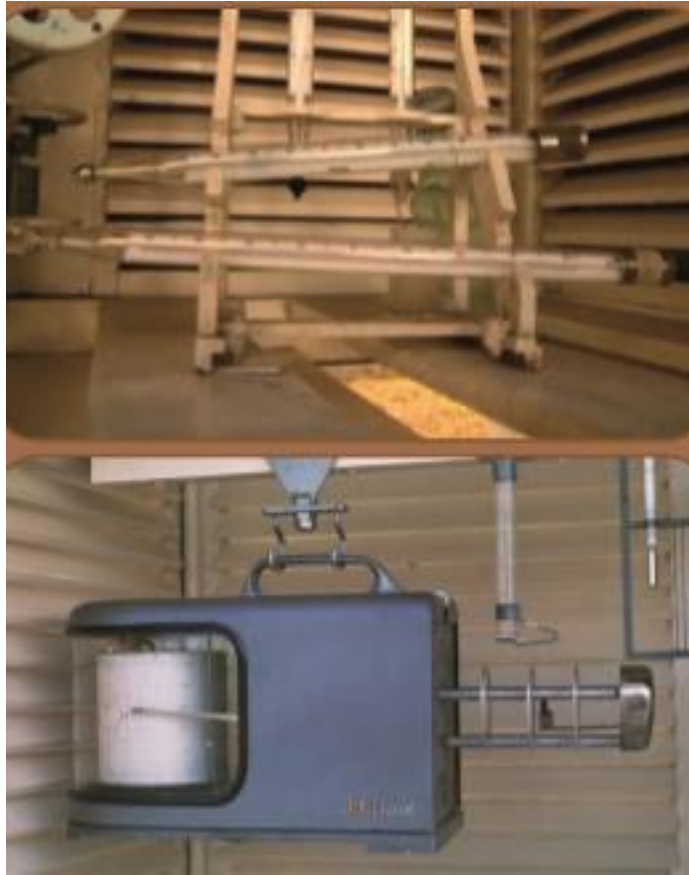
Figura 3.2 Arriba: Termómetro de máxima y mínima (abajo). Abajo: Termógrafo en un abrigo meteorológico.
