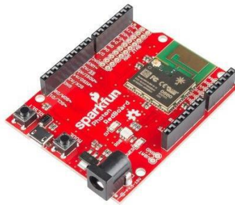
Figura 3.25 Módulo de conexión WIFI "DEV-13321"
