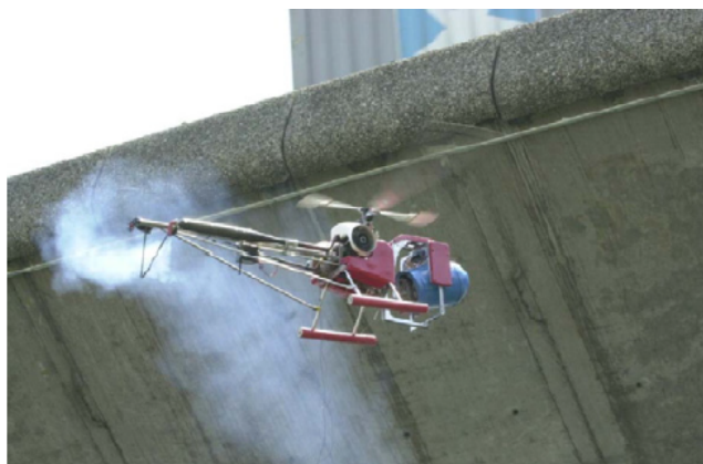
Figura 2.4: UAV utilizado para la detección de fisuras en puentes.
