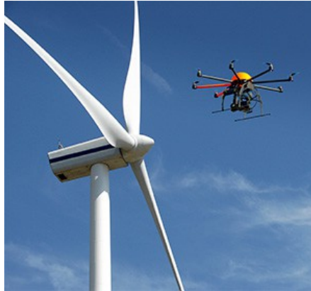
Figura 2.6: UAV utilizado para el mantenimiento preventivo a un aerogenerador.
