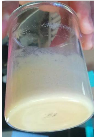
FIGURA 1.2. Dispersión de proteína con [P]=20\% en el reactor de 100 mL con agitación magnética.
