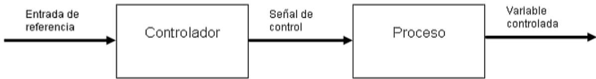
Figura 2.3 Elementos de un lazo de control abierto.
