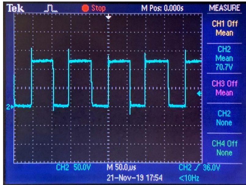
Figura 4.15 Señal de conmutación en motor de C.D implementando la red SNUBBER medida en el punto K del diagrama completo.
