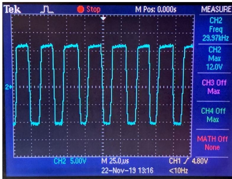
Figura 4.17 Señal senoidal convertida a señal cuadrada para ser aplicada a la entrada del LM331 medida en el punto D del diagrama completo.
