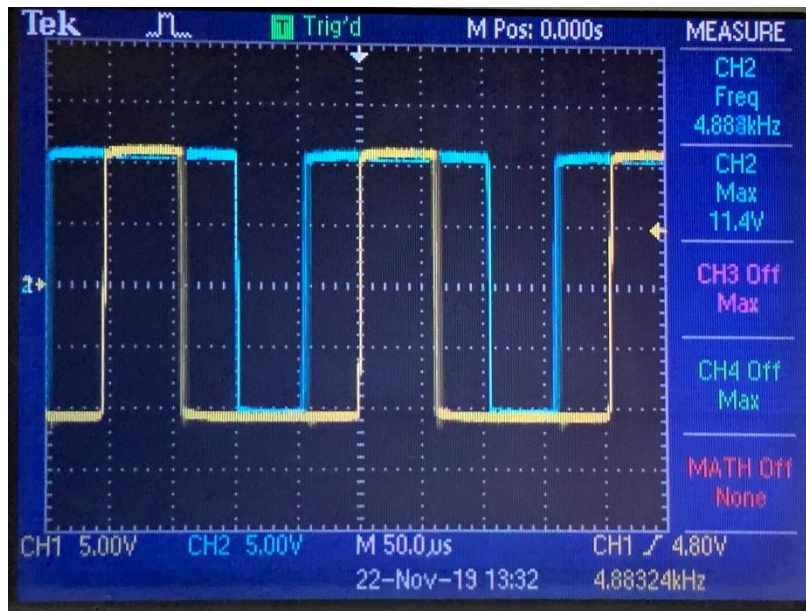
Figura 4.20 Señal +PWM (amarillo) y -PWM (azul) medida en el punto I del diagrama completo.
