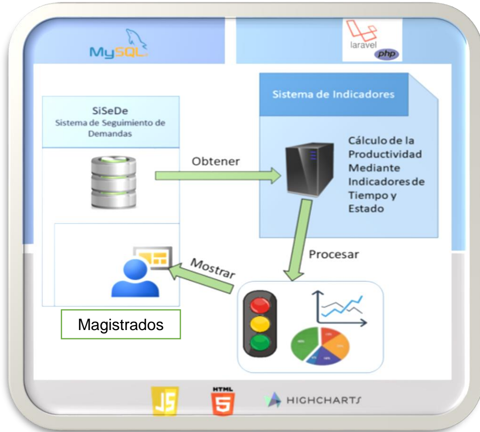
Figura 3 Modelo conceptual de la integración de indicadores de productividad al SI SiSeDe
