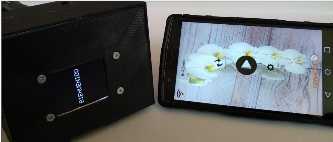
**Figura 53. Nodo móvil y aplicación Android.**
