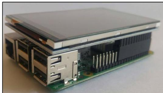
Figura 45. Raspberry Pi 3 y pantalla táctil
