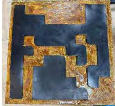
Figura 1D. Refuerzos poliméricos con disposición aleatoria.
