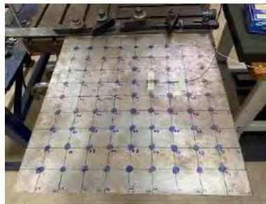
Figura 40. Puntos discretizados para la medición de la vibración libre y forzada mediante acelerómetros.
