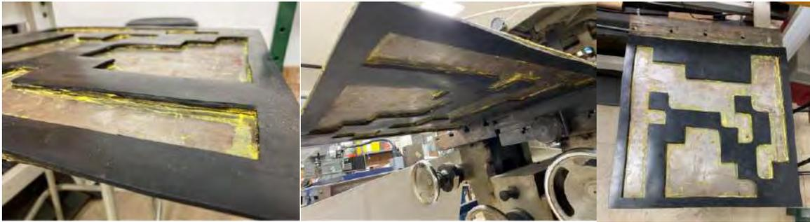
Figura 43. Configuración de refuerzo a 37 Hz con doble capa.
