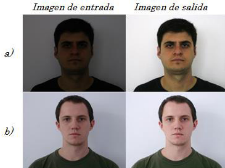
Figura 3.3 a) Imagen de entrada con mala iluminación, b) imagen con buena iluminación. La imagen de salida muestra el resultado de aplicar la capa de foto receptores a la imagen de entrada.
