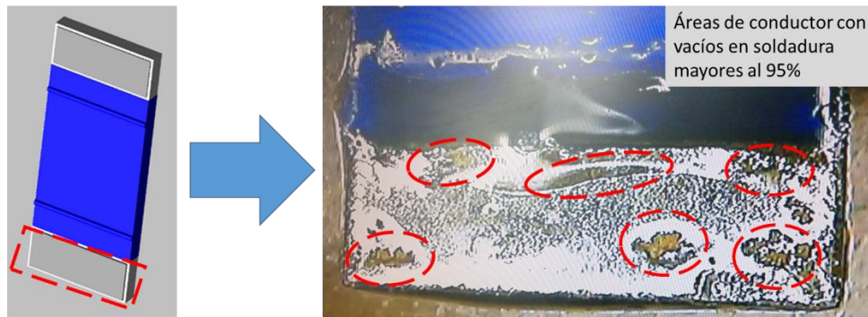
Figura 51 - Elemento después de prueba de soldabilidad. La imagen superior derecha muestra una resistencia después de haber sido sometida a la prueba de soldabilidad de acuerdo con el estándar J-STD-002D. El elemento es un ejemplo de una pieza rechazada debido a que muestra espacios sin soldadura menores al 95% del requerido por el estándar. (Autoría propia 2020)
