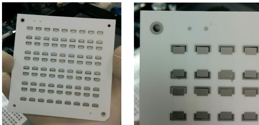
Figura 44 - Capa conductora frontal y trasera. Primera capa conductiva Frontal y Trasera, aplicada y horneada sobre el sustrato de cerámica. El conductor se ha adherido al sustrato por medio del proceso de horneado. (Autoría propia 2019)
