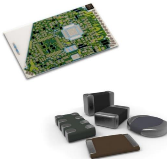
Figura 13 - Componentes SMD. Creados por medio de proceso de Películas Gruesas, en la parte superior se muestra una tablilla con un circuito electrónico, en la parte inferior se muestra un conjunto de resistencias y capacitores elaborados por medio del proceso de Película Gruesa. (Heraeus 2019)
