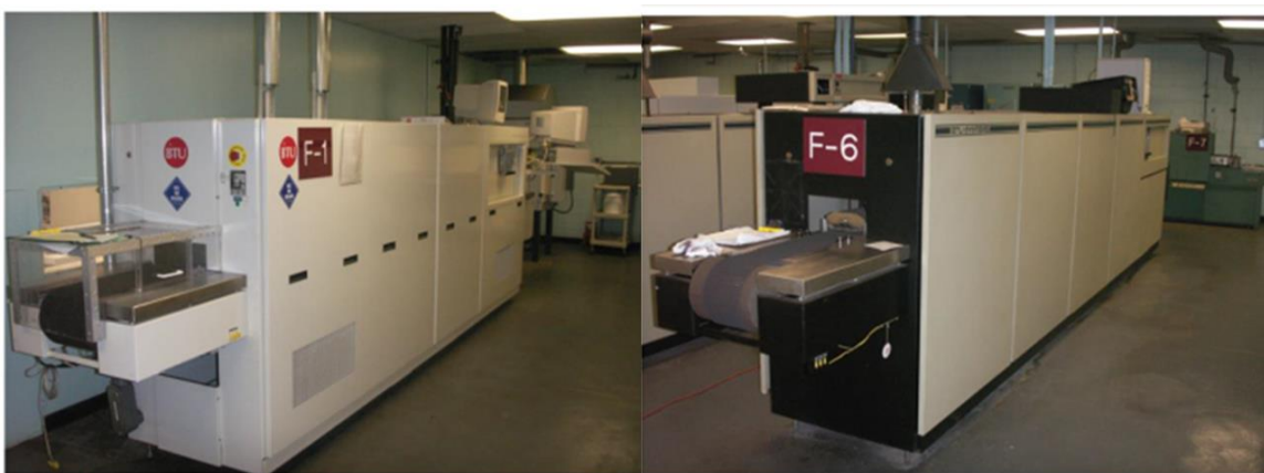
Figura 32 - Hornos de curado. Imagen mostrando Hornos de curado convencionales utilizados para el horneado de pastas/tintas en proceso de películas gruesas, Fuente: HMI printers, 2019
