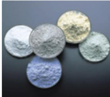
Figura 21 - Aglutinantes de tintas. La imagen muestra el componente aglutinante utilizado en una pasta/tinta que tiene como función adherir las sustancias funcionales al sustrato sobre el cual se pinta. Fuente: Heraeus, 2019
