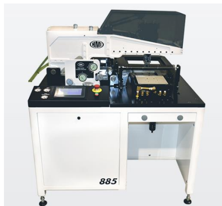
Figura 29 - Máquina de impresión. Máquina de impresión semiautomática utilizada en la manufactura de elementos por proceso de películas gruesas, Fuente: HMI printers, 2019
