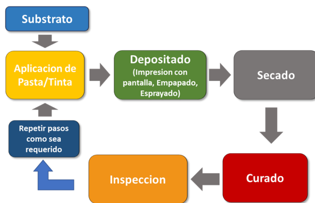
Figura 40 - Diagrama de bloques. Diagrama de bloques básico para un proceso de Impresión de Película Gruesa de resistencia (autoría propia, 2019).
